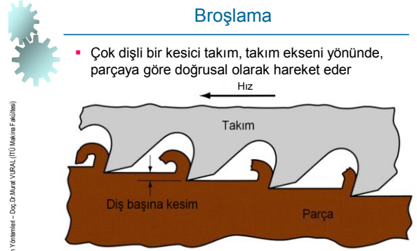
Şekil 22.33 Broşlama işlemi.
