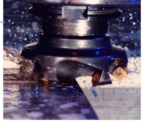
Döndürülebilir insertler kullanan yüksek hızlı bir alın frezeleme 47
